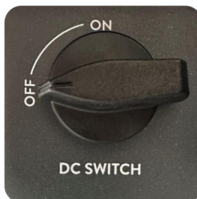
Abbildung 18: Deaktivierung der PV Gleichstromversorgung_1.2
